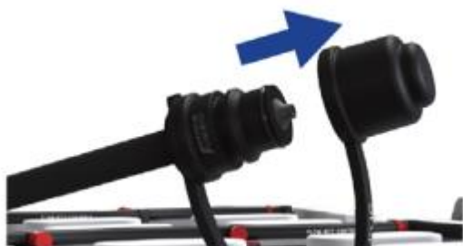
Рис. 17: Снимите защитный колпачок
